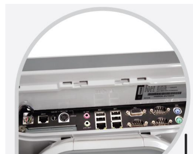
Интерфейсные разъемы в верхней части корпуса – удобный доступ.
