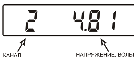
Рисунок 4. Вид дисплея в режиме калибровки каналов измерения напряжения питания
