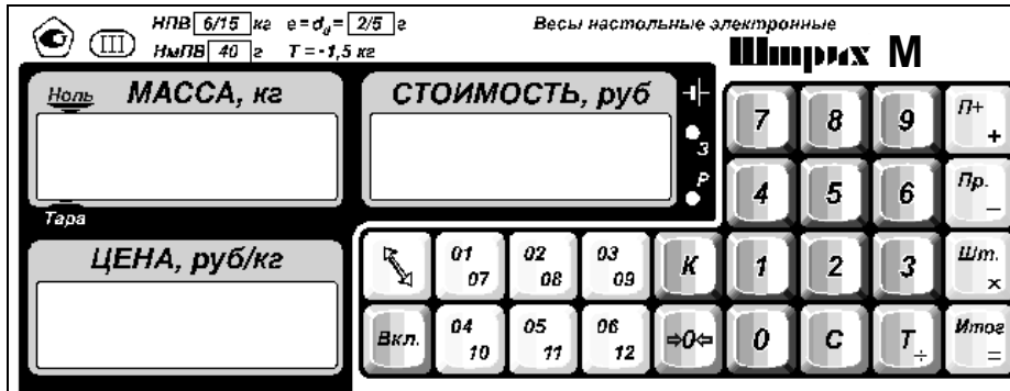
Рисунок 4 - Клавиатура весов Штрих М
