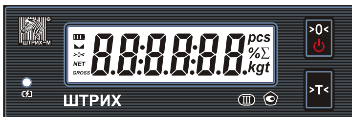
Рисунок 7 - Клавиатура весов Штрих М
