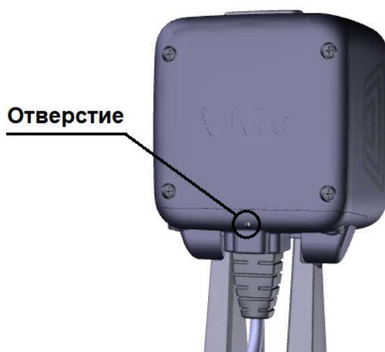
Рис. 3 Отверстие для доступа к защелке кабеля
